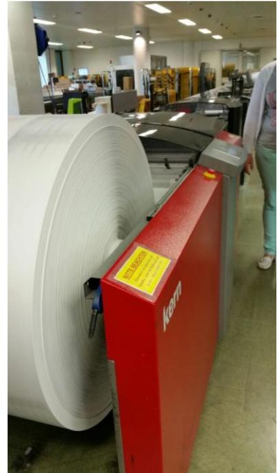
Die Druckmaschinen laufen knapp 6 Tagen die Wochen und werden im 3-Schichtsystem bedient. Um einen reibungslosen Arbeitsablauf zu gewährleisten, sind eigene Techniker für Wartungsarbeiten und Reparaturarbeiten eingestellt. Auf Grund der Dauerbelastung müssen trotzdem die Maschinen nach 5 – 7 Jahren ausgetauscht werden.
