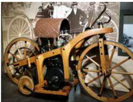
Daimler Reitwagen: 1-Zylinder /4-Takt, 264 cm<sup>2</sup> Hubraum, 0,5 PS, Maximalgeschwindigkeit 12 Stundenkilometer, Baujahr 1885
